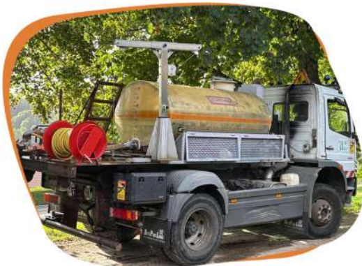
Le mélange d'engazonnement est transporté dans un camion de la ville : il est prêt à être projeté dans les allées.
